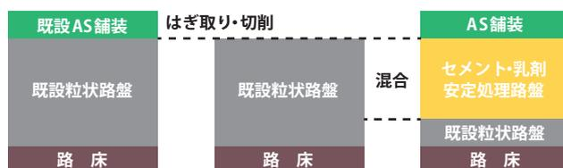
**1.** 既設アスファルト舗装をそのまま安定処理し、かさ上げを行う場合
